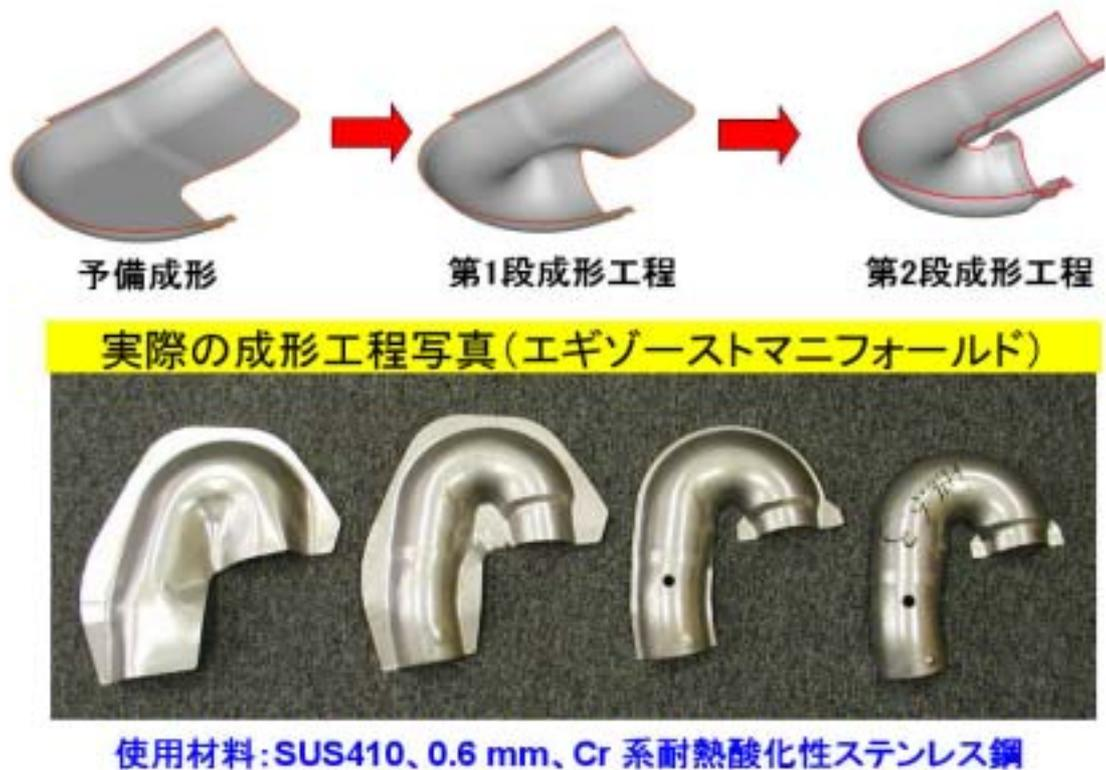
図-10 多段成形実機比較検証したマニホールド
