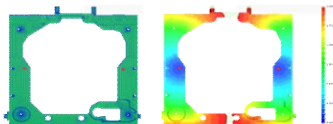
図10 ゲート位置の最適化解析例
